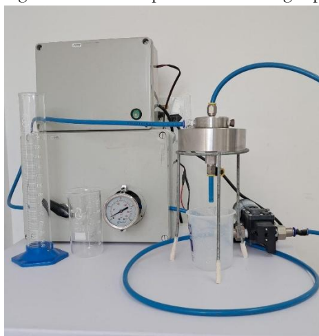
Figura 1: Sistema de permeabilidade à água por pressurização
