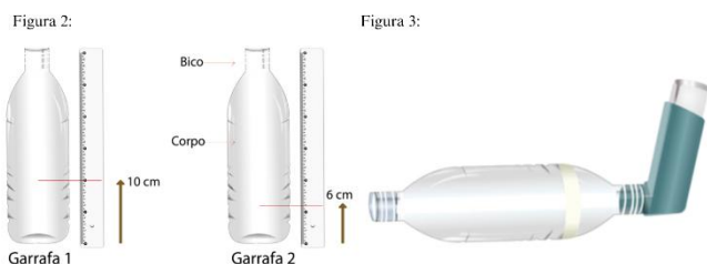
Figura 2: Medição para cortes nas garrafas PET. | Figura 3: Modelo 1 finalizado. (Fonte figura 2 e 3: Frade; CONSELHO FEDERAL DE FARMÁCIA, 2024).
